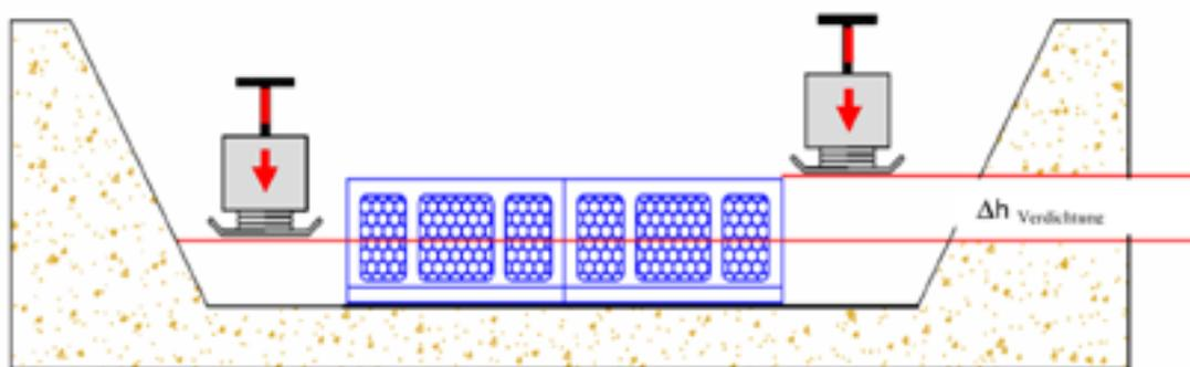
Beim Einbau der Rigolette Sickerschächte unterhalb von Stellplätzen und Verkehrswegen, darf erst nach einer Überdeckung von mind. 30 cm mit einem geeigneten Verdichtungsgerät verdichtet werden. (leichte Rüttelplatten oder andere flächig wirkende Geräte). Danach erfolgt die lagenweise Verdichtung alle 20 cm bis zur Oberkante des Straßenoberbaus.
